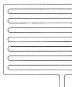
**a spirale** usato nella maggior parte delle applicazioni civili perché permette una maggiore uniformità della temperatura superficiale (i tubi di mandata e ritorno si sviluppano fra loro in modo alterno) e consente una maggiore facilità durante la posa in opera (sono richieste solo due curve a 180°: quelle in cui lo sviluppo della spirale si inverte).
